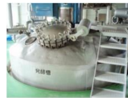
発酵槽（イブタノール生産）
